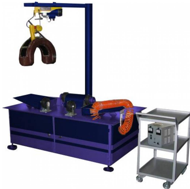
Стенд дефектоскопии валов роторов ОЗЭ1.412232.007
